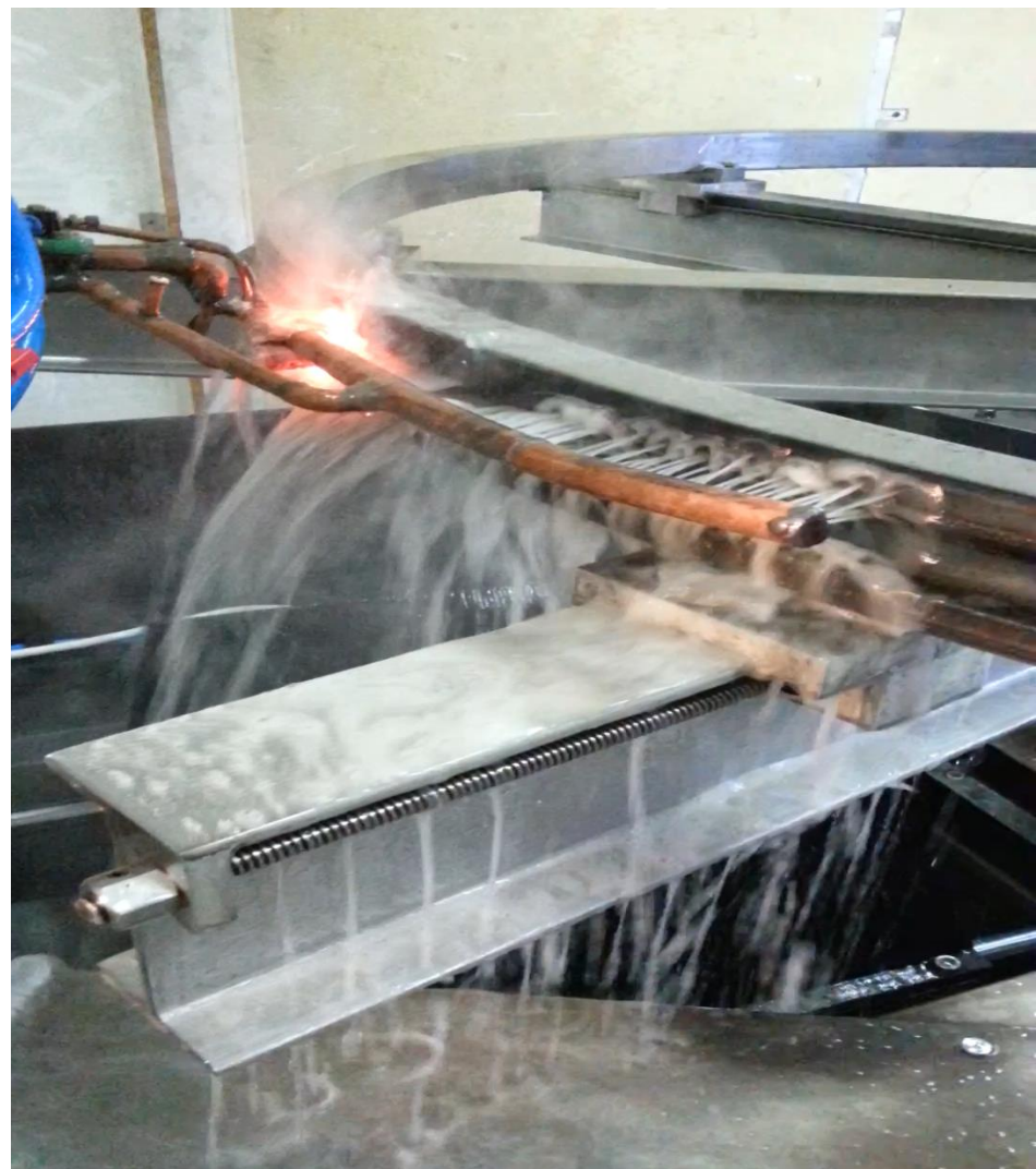
Z.14. Proces hartowania bieżni zewnętrznej pierścienia łożyska kulkowego.
