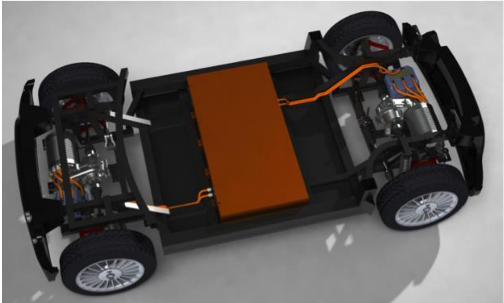
Układ pakietów baterii trakcyjnych i zespołów napędowych – wersja finalna
