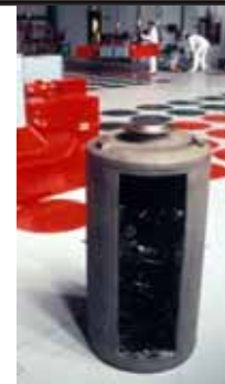
Odpady zeszkliwione - Przekrój- (180 l)
